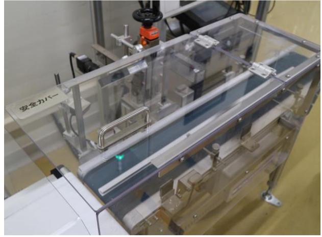
動いている機械に手が入らないよう、全面にカバーを設置しています。また意識付けのために“安全カバー”の表示をしています。
