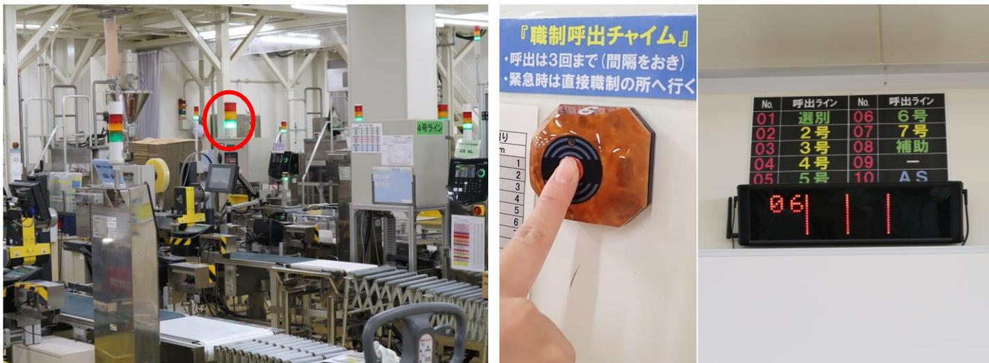
聴覚障がいのある社員が生産設備の運転状況などを光や色で感知できるよう、シグナルタワーを導入しています。また、ラインの責任者に連絡する呼び出しボタンを設置することで、迅速な対応を可能にしています。
